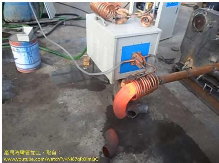
▲图 1-1：传统弯头是在加工厂以高周波加热弯曲制造 (摘自 Youtube)
