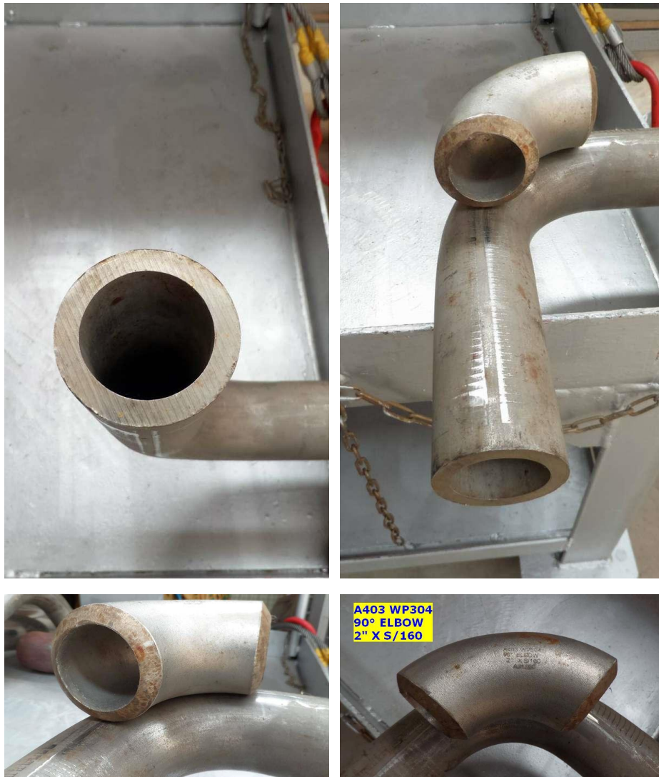
▲图 2-5：2 吋 160s SUS304 传统弯头和 DH 弯头比较
