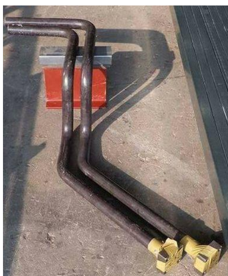
▲图 2-1：1.25 吋 160s(厚度 6.4t)油压管线(连续 4 弯管)、ISO 配管图
